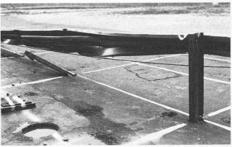
Bild 8. Aufgeklafftes Kastenprofil nach dem Anprall eines Lastwagens (10 t, 71 km/h. 15°)
