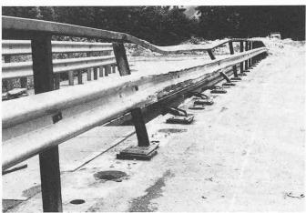
Schaden an der Leitschranke mit Planke Profil A und Handlauf, nach Bild 10. einem Lastwagenanprall (5,6 t, 71 km/h, 15°)
