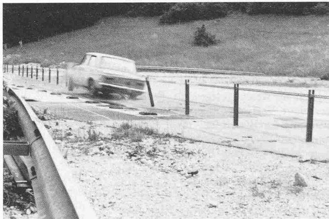
Bild 3. Personenwagenversuch an der Seilleitschrake (1 t, 98 km/h, 20°)
