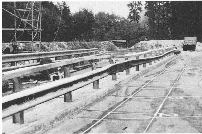
Bild 14. Schaden nach einem Lastwagenversuch an der modifizierten Leit- schranke mit Pfosten IPE 160 (10 t, 75 km/h, 15°)
