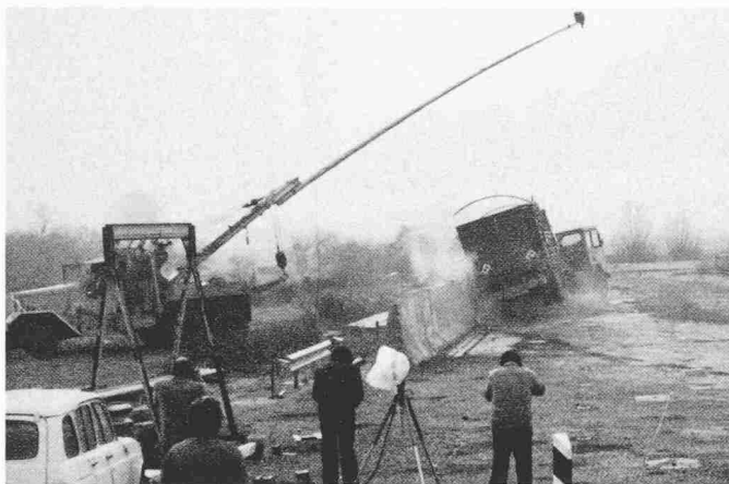
Bild 13. Lastwagenversuch an der 1,5 m hohen Betonmauer mit New-Jersey-Profil (französischer Versuch, 30 t, 60 km/h, 20°)
