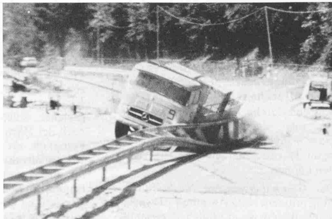
Bild 5. Sehr gute Umlenkung des Versuchslastwagens durch die doppelte Distanzleitschrake (10 t, 68 km/h, 15°)
