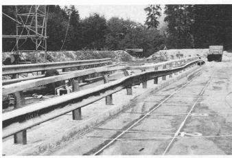
Schaden nach einem Lastwagenversuch an der modifizierten Leitschranke mit Pfosten IPE 160 (10 t, 75 km/h, 15°)
