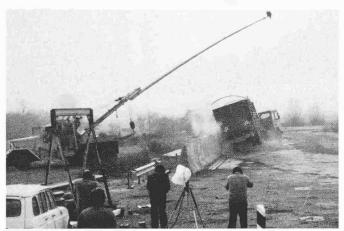
Lastwagenversuch an der 1.5 m hohen Betonmauer mit New-Jersey-Profil (französischer Versuch, 30 t, 60 km/h, 20°)
