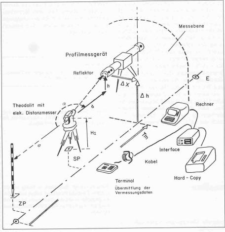
Bild 3. Anordnung des Gerätes im Tunnel
