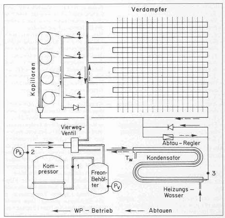
Bild 1. Prinzipschema der Kältemittel-Kreisläufe
