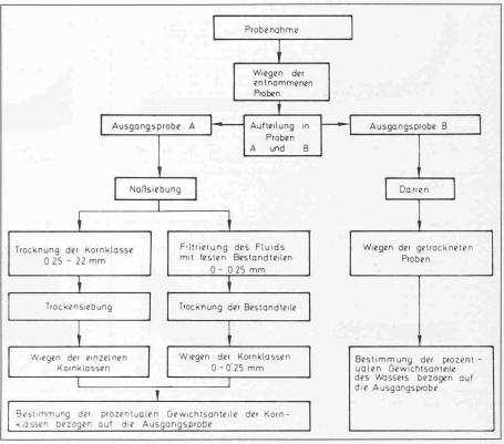
Bild 8. Bestimmung der Prüfmerkmale
