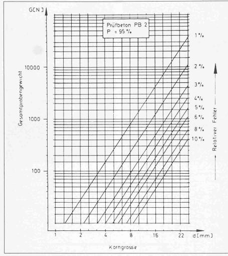
Bild 6. Nomogramm zur Bestimmung des Gesamtprobengewichts
