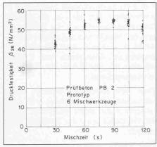
Bild 12. Einfluss der Mischzeit auf die Betondruckfestigkeit
