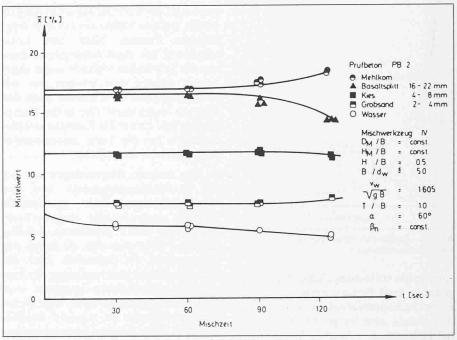
Bild 13. Mittelwert der Betonkomponenten in Abhängigkeit zur Mischzeit
