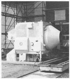
Bild 2 (oben). Trommelmischer
