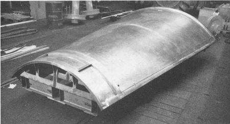
Bild 4 (oben). Fertiggestellte konische Form
