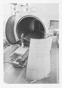
Bild 5 (rechts). Herstellung der Haube bei Contraves in Zürich. Das konische Element im Vordergrund ist bereits mit dem thermischen Schutz ausgerüstet. Im Hintergrund liegt die zylindrische Form auf dem Boden des Polymerisationsofens
