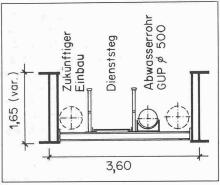
Bild 3. Querschnitt der Brücke
