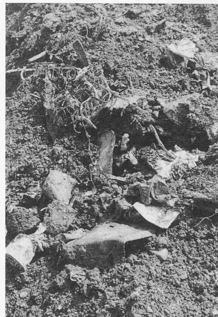
Bild 1. Kehrriechtschlacke, wie sie aus der Verbrennungsanlage anfällt (Nahaufnahme)
