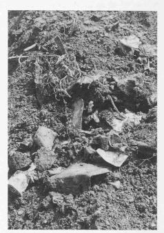
Bild 1. Kehrichtschlacke, wie sie aus der Verbrennungsanlage anfällt (Nahaufnahme)
