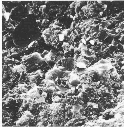
Bild 6. Mikrogefüge von erhärteten Pasten aus PC, HK und AS Typ B. Aufnahme mit dem Rasterelektronenmikroskop (REM). Vergrößerung 1400 × Links: Portlandzement PC. Mitte: Hydraulischer Kalk HK. Rechts: Aktivierter Kiesschlamm AS Typ B
