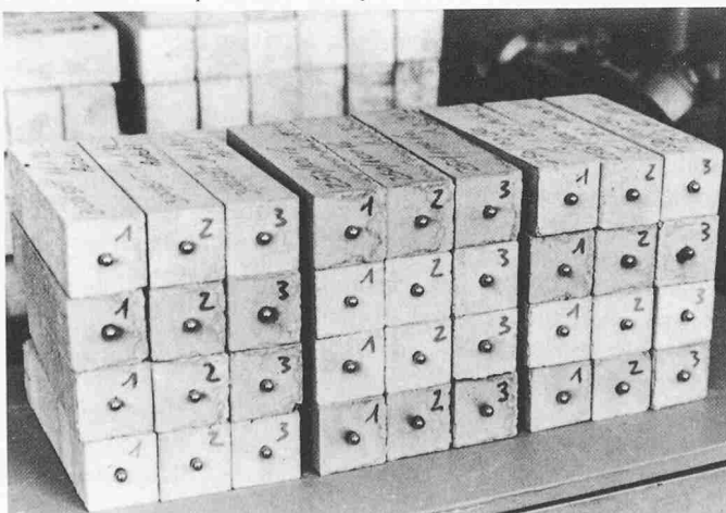
Bild 1. Versuchskörper. Links: Mörtelprismen 40×40×160 mm. Rechts: 3-Steinkörper
