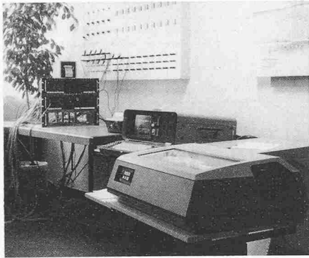
Bild 4. Programmier- und Testplatz für speicherprogrammierbare Steuerungs- und Regelungssysteme
