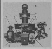
Brenner OE-3 Zweistoff, modulie-rend, ohne Haube, von oben. 1 Brennergehäuse, 2 Luftkasten, 3 Luftdruckwächter, 4 Stellantrieb, 3 Luftdruckwächter, 4 Stellantrieb, 5 Zündtransformator, 6 Ventilator, 7 Flansch, 8 Brennerkopf, 9 Flammenüberwachung, 10 Ölpumpe, 11 Pumpenmotor, 12 Brennermotor.
