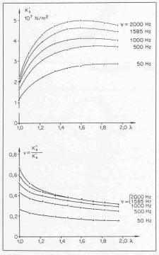
Bild 5. Realteil des Probenmoduls sowie Verlustfaktor
