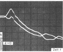
Bild 12. Zeitlicher Verlauf der Randspannungen (beide positiv aufgezeichnet), gemessen im Abstand 8,4 cm (entspricht 3 h) von der Bruchstelle (Araldit B, l = 65 cm, h = 2,8 cm, 50 µs/6 N/mm² p. div.)
