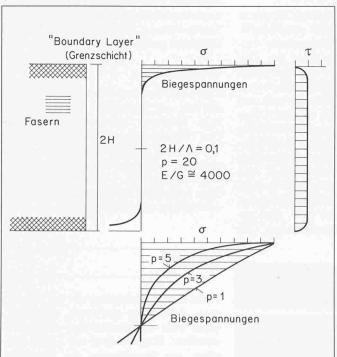
${\it Bild~10.} \quad {\it Vergleich~Theorie-Experiment~bei~Biegewellen~in~faserverst\"{a}rkten}$   ${\it St\"{a}ben}$
