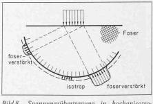
Bild 8. Spannungsübertragung in hochanisotropen Medien
