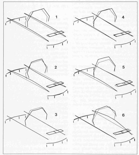
outre, 18 éléments de couplage rigide permettent de tenir compte des discontinuités d'axe entre certaines poutres, 6 éléments élastiques simples et 2 matrices de flexibilité servent à prendre en considération la souplesse mécanique entre voie de roulement et support, ce dernier subissant les excitations correspondant aux spectres de réponse dus aux diverses catégories de séismes. La connexion de tous ces éléments se fait en 59 nœuds comportant chacun 6 degrés de liberté, soit au total 354.
