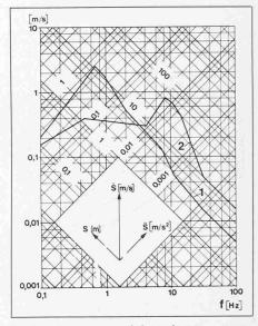
Fig. 2. Diagramme quadrilogarithmique montrant à la fois, en fonction de la fréquence f et pour un coefficient d'amortissement \( \xi \) fixé à 5 \( \xi \), le déplacement \( \xi \), la pseudocélérité \( \xi \) et la pseudoaccélération \( \xi \) sous forme de deux spectres de réponse correspondant à un séisme horizontal 1 et vertical 2
