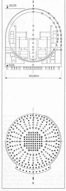
Bild 7. Reaktorgebäude Angra 2. Ansicht und Grundriss mit der Lage der Pfähle
