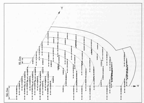
Bild 8. Diskretisiertes Pfahl-Boden-System
