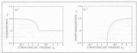
Bild 3. Dynamischer Steifigkeitskoeffizient
