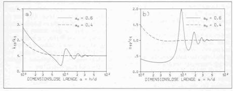
Bild 4. Konvergenz des dynamischen Steifigkeitskoeffizienten, niedriger Frequenzbereich
