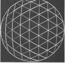
Bild 3b. Modell des Tragsystems einer Holznetzschale (Draufsicht)
