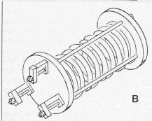
Bild 29. Hilfsvorrichtungen für das Peenen von Federn unter Vorspannung.
