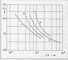
Bild 23B. Lebenserwartungs-Charakteristik stellt auf direktem Wege durch Prüfung des Dauerschwingungsverhaltens von Schraubendruckfedern Draht mit einem Durchmesser 4,5 mm für eine Unterspannung tu von 15 kg/cm²
