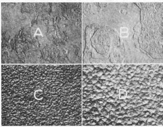
Bild 9. Vier Beispiele des Oberflächenzustandes von Blattfedern in fünffacher Vergrösserung.
