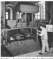
Bild 25A. Zusatzeinrichtung für das Shot-peenen von Spiralfedern in der Durchlaufanlage zur Behandlung von Schraubenfedern gemäss Bild 25 und bestehend aus zwei an der Vorderseite der Maschine eingebauten Drehtischen mit je 600 mm Durchmesser, die wechselweise in die Strahlzone unter eines der beiden Schleuderräder eingeschwenkt werden können
