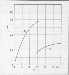
Bild 7. Peenen von Werkstücken aus Stahl. Richtwerte für die Strahlintensität in Funktion der Materialstärke an der kritischen Stelle des zu behandelnden Werkstückes, wobei der Querschnitt mit der geringsten Materialstärke massgebend ist.
