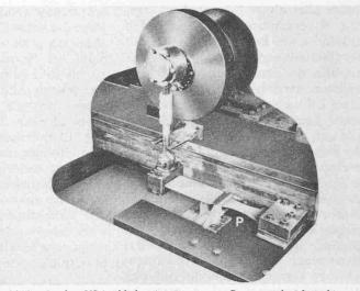
Bild 10. In den USA übliche Ausrüstung zur Dauerstandprüfung bis zum Bruch von sogenannten Flachbiegeproben, die als Prüfmuster aus der für die Herstellung von Blattfedern bestimmten Flachstahlqualität zur Ermittlung von Lebenserwartungs-Charakteristiken auf indirektem Wege dienen. Die Apparatur unterwirft das Prüfmuster ständig wiederkehrenden, gleichartigen Wechselbeanspruchungen auf Biegung unter Schwellbelastung.
