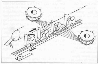
Arbeitsprinzip der Anlage zum Peenen von Kupplungsfedern im Durchlaufverfahren auf beiden Seiten gleichzeitig und des in der Maschine gemäss Bild 17 angewandten Transportsystems, wobei die Tellerfedern mittels mit Nocken versehener Förderkette stehend durch den Strahlraum geführt werden (siehe Bild 18B)
