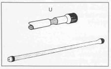
Bild 5. Torsionsstab. Diese federnden Konstruktions-Elemente werden vielfach zusätzlich als Sicherung gegen Überlast verwendet und erhalten dann im zylindrischen Teil eine Querschnittsverengung (Detail U). Während der Shot-peening-Behandlung wird diese Stelle mit einer Gummimanschette gegen die Wirkung der Bestrahlung geschützt
