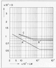
Festlegung der Strahlintensität gehört stets auch die Angabe der einzuhaltenden Flächenüberdeckung. Was die Angaben in Bild 7 betrifft, beziehen sich diese auf eine Flächenüberdeckung von 98 Prozent. Im Diagramm kommen zwei der genormten Almen-Test-Prüfplättchen vor. Für die Umrechnung ist auf Bild 8 verwiesen.
