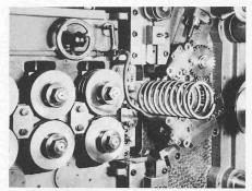
Bild 22. Formen einer Schraubendruckfeder in einer automatisch arbeitenden Federnformmaschine für Drahtstärken bis 14 mm Drahtdurchmes-
