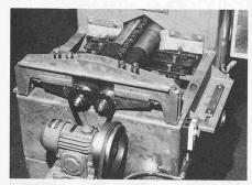
Bild 28A. Beladestation einer Shot-peening-Maschine bestimmt für eine Fertigungsstrasse zur Herstellung von Ventilfedern mit 20 bis 50 mm Durchmesser und mit bis zu 80 mm Federlänge. In der Abbildung ist die Übergabestation, welche die Ventilfedern in die Beladestation der Peening-Maschine einlegt, nicht zu sehen.
