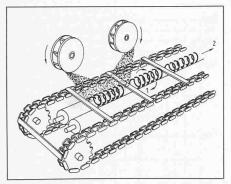
Bild 24. Arbeitsprinzip und grundsätzlicher Aufbau von nach dem Längsstrahl-Einstrang-Prinzip arbeitenden, mit zwei Schleuderrädern ausgerüsteten Maschinen zum Peenen von Schraubenfedern im Durchlaufverfahren.
