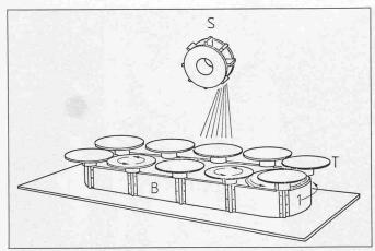
Bild 15. Arbeitsprinzip einer mit einem einzigen, auf dem Dach der Anlage aufgebauten Schleuderradausgerüsteten Maschine zum Peenen von Kupplungsund Tellerfedern. Zum beidseitigen Peenen ist zweimaliger Durchgang unter dem Schleuderrad erforderlich mit Wenden der Feder zwischen dem ersten und dem zweiten Durchgang.
