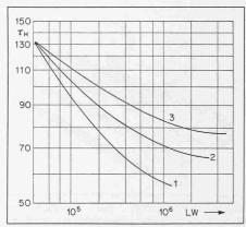
Bild 23A. Lebenserwartungs-Charakteristik für Schraubenfedern, ermittelt auf indirektem Wege durch Prüfung auf Dauerstandfestigkeit von geraden Stäben aus Chrom-Vanadin-legiertem Ventilfederdraht mit 4 mm Drahtstärke und mit einer Zugfestigkeit von etwa 165 kg/mm². Unterspan $nung \tau_u = 10 \, kg/mm^2 [11].$
