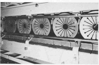
Strahlraum der Maschine Bild 17 mit den auf dem Förderband stehend durchlaufenden und dabei eine rotierende Bewegung ausführenden Kupplungsfedern. Die Werkstücke werden auf beiden Seiten gleichzeitig durch die an den Längswänden horizontal montierten Schleuderräder gepeent. Bild: Maschinenfabrik Georg Fischer AG, Schaffhausen
