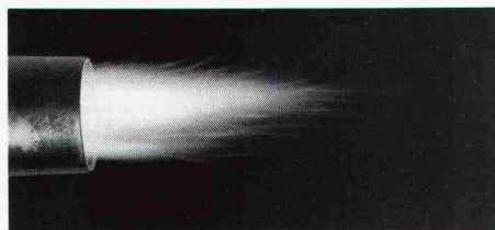
Flammenbild eines Oertli Ceramic-Brenners mit 1,0 kg/h Ölleistung.
