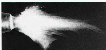
Flammenbild eines Brenners mit konventioneller Verbrennungseinrichtung und 1,0 kg/h Ölleistung.
