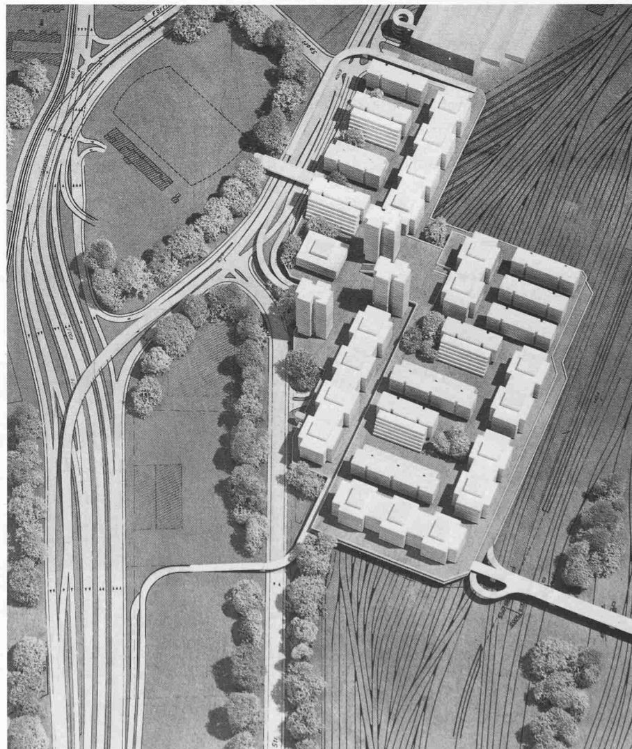
Bild 3. Die Bauten des Engrosmarktes waren so zu projektieren, dass auf einer zweiten Ebene über dem Marktareal und dem angrenzend geplanten Gleisfeld der SBB eine Zusatznutzung möglich ist
