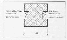
Bild 10. Bei jeder Stütze ist die Anschlussmöglichkeit von Installationen der Markthalle und der darüberliegenden Zusatznutzung gegeben
