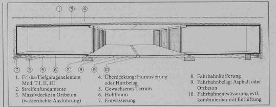
werden je nach Gesamtbelastung und Baugrundverhältnissen auf Sohlnormalspannungen oder Setzungen berechnet. Die vorfabrizierten Garagenelemente aus Beton BH 375 verkürzen die Bauzeit wesentlich. Der eingebaute geschlossene Betonboden ist vakuumiert, spezialgehärtet
