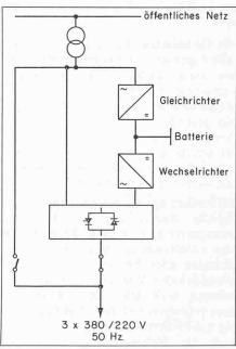
Bild 1 Blockschema für eine unterbrechungsfreie Stromversorgungsanlage
