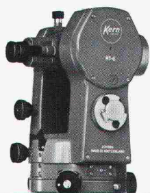
Kern K 1-S. Ingenieurtheodolit mit Skalenablesung
