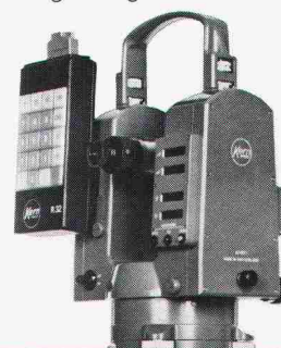
Kern E 1. Elektronischer Theodolit mit Registriergerät
