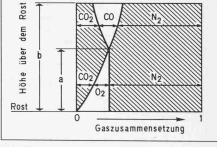
Bild 10. Gaszusammensetzung in verschiedenen Höhen über dem Rost [27]
