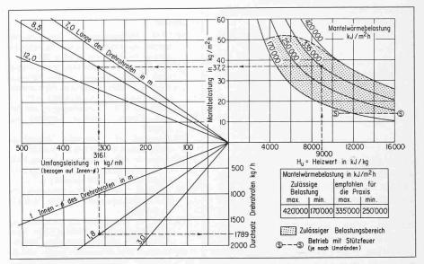
Bild 13. Leistungsnomogramm für Drehrohröfen
