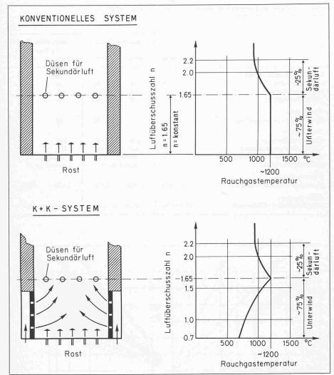
Bild 8. Temperaturverlauf im Feuerbett bei einem konventionellen und dem K + K-System [35]
