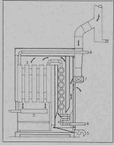
Schnitt durch Kessel. 1 Gasanschluss, 2 Atmosph. Erdgasbrenner, 3 Primär-Wärmetauscher, 4 Sekundär-Wärme-tauscher (Kondensator), 5 Kondensat-ablauf mit Syphon, 6 Heizungsrück-lauf, 7 Abgasventilator, 8 Heizungsvorlauf
