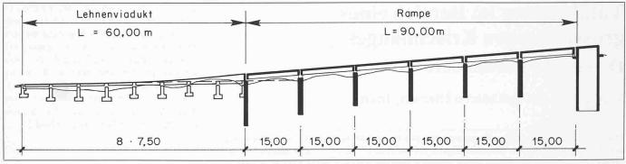
Bild 3. Längsschnitt Rampe
