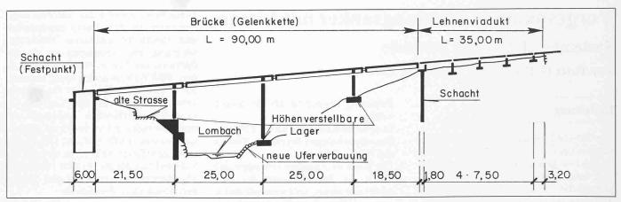
Bild 4. Längsschnitt Brücke
