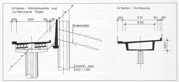
Bild 5. Querschnitte Rampe und Brücke
