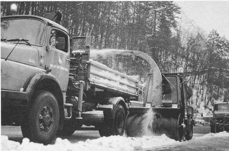
Bild 8. Randwallräumung mit Zapfwellenfräse an Kleinkommunalfahrzeug (Ladezeit je Lastwagen: unter 3 Minuten)
