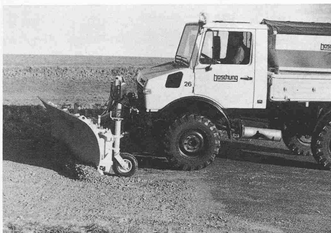
Bild 7a. Mehrscharfederpflug in «Schwimmstellung» gräbt sich in die Chausseierung und blockiert das Trägerfahrzeug
