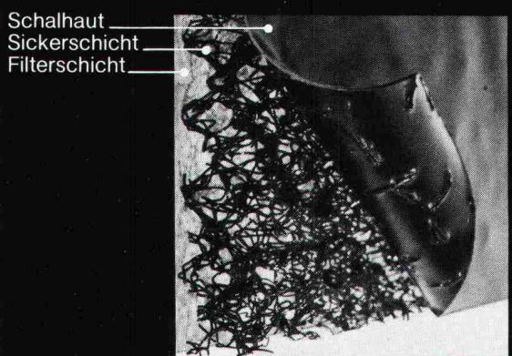
«Enkadrain CK leitet extreme Wassermengen sicher ab, wirkt als Dilatation und nimmt hohen Frischbetondruck auf.»
