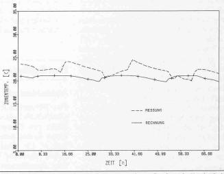
Bild 4. Temperaturverhalten in der Kernzone bei Anlagebetrieb, Vergleich des Ist-Zustandes mit dem nach Spezifikation errechneten Soll-Zustand
