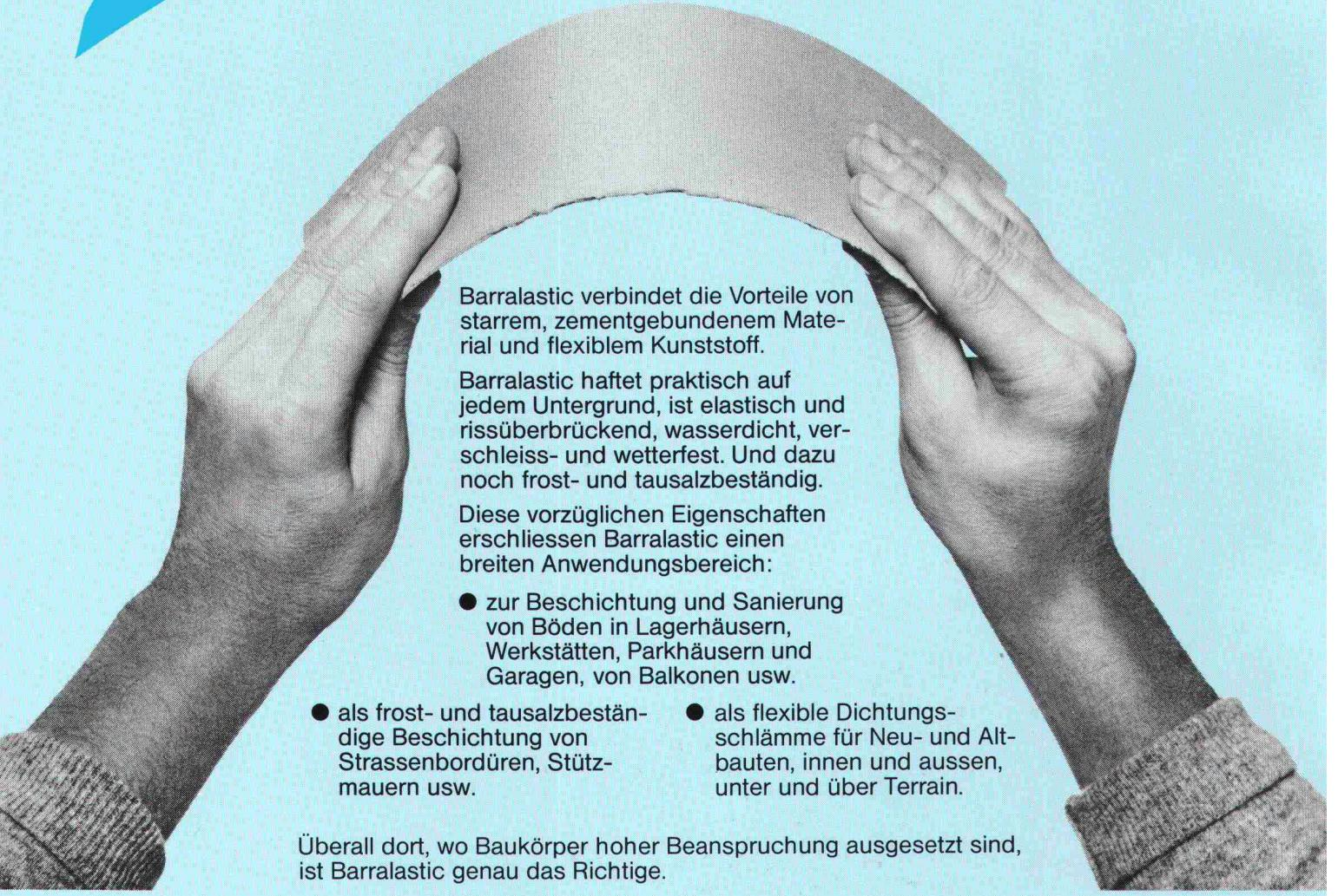
Barralastic verbindet die Vorteile von starrem, zementgebundenem Material und flexilem Kunststoff.
