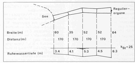
Bild 5. Geometrie des Gerinnes für Beispiel 1. Längenprofil
