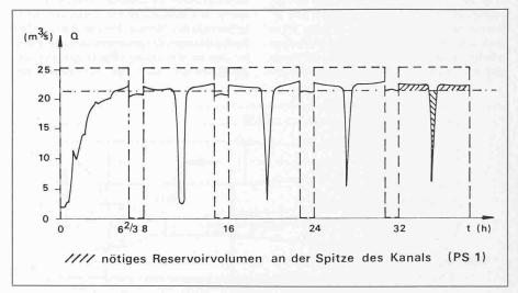
Bild 10. Ganglinien der Summe der aus dem Kanal gepumpten Wassermengen - - - - und der den Kanal bei Pumpstation PSI passierenden Wassermenge ---- für Anfahren aus dem Ruhezustand in einen Betriebszustand mit intermittierender Maximalnachfrage (sechszweidrittel Stunden) und Abstellen der Pumpen (eineindrittel Std.
