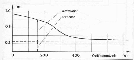
Bild 7. Maximale Spiegelabsenkung in Funktion der Öffnungszeit
