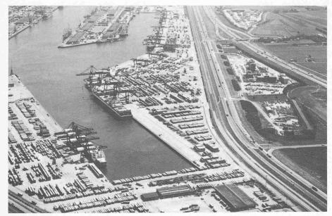
Container-Terminal im Eemshaven in Rotterdam mit 1,1 Mio. m² Umschlag- und Lagerflächen befestigt wie in Bild 2 gezeigt
