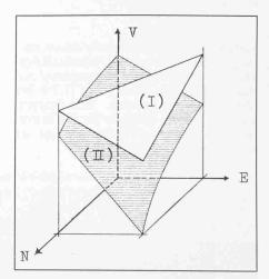
Bild 1. Fahrkomfort von Betonstrassen mit Dübel (I) und ohne Dübel (II) in Abhängigkeit von der Belastung durch Verkehr (V), von Einflüssen der Natur N und vom Erosionswiderstand E des Unterbaus
