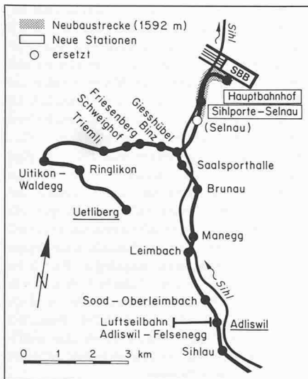
Verlängerung der Sihlthal-Zürich-Uetlibergbahn (SZU)
