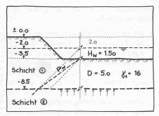
Bild 2. Bemessungsmodell hydraulischer Grundbruch
