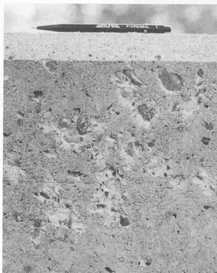
Bild 4. Erste Anzeichen von Frostschäden im Beton: Ablösen von oberflächlichen Feinstmörtelschichten besonders über grösseren Zuschlagkörnern
