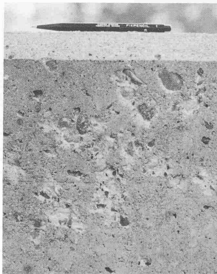
Bild 4. Erste Anzeichen von Frostscha den im Beton: Ablösen von oberflächlichen Feinstmörtelschichten besonders über grösseren Zuschlagkörnern
