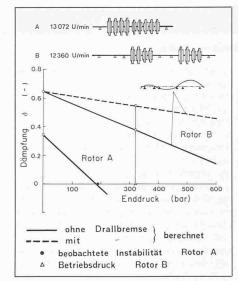
Bild 16. Untersuchung der Rotorstabilität
