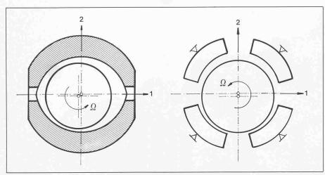
Bild 5. Gleitlagertypen, links Festflächenlager, rechts Kippsegmentlager
