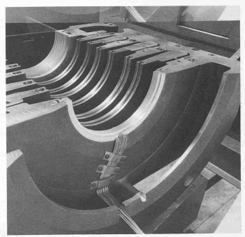
Bild 14. Messlabyrinth im Gehäuseunterteil
