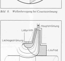
Bild 10. Deckscheibenlabyrinth in einer Radialstufe Bild 11. Strömung im Labyrinth
