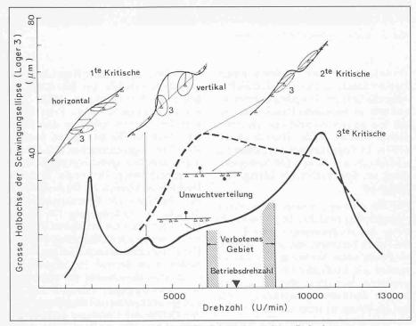
Bild 6. Unwuchtschwingungen einer Sauerstoffverdichteranlage auf Zweiflächenlagern
