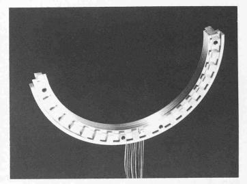
Bild 15. Drallbremse mit Messlabyrinth
