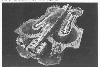
Bild 2. Radialverdichter in Topfbauweise
