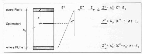
Bild 2. Dehnungszustand bei Erwärmung der Fahrbahnplatte
