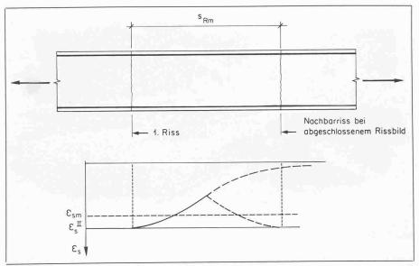
Bild 1. Rissmodell; Stahldehnung bei Risslast und abgeschlossenem Rissbild
