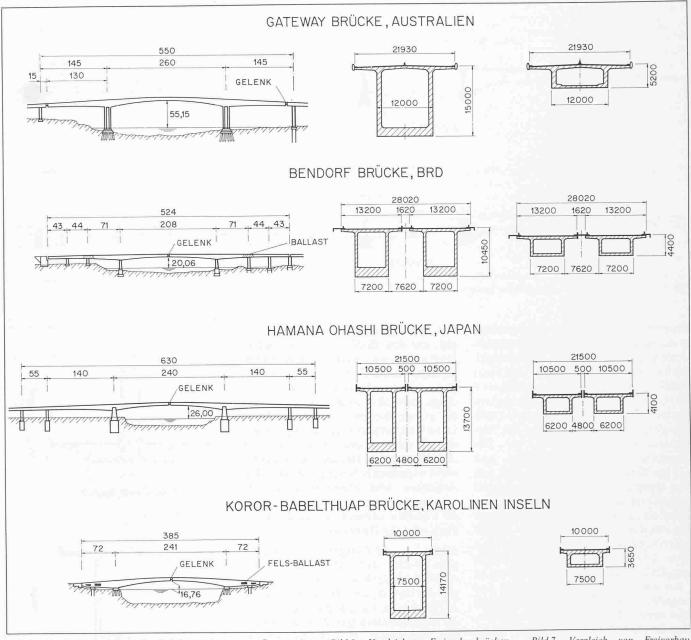
Bild 5. Vergleich von Freivorbaubrücken mit grossen Spannweiten (Längsrichtung)
