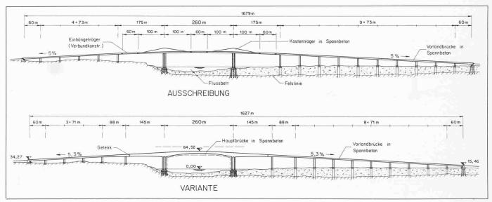
Bild 2. Vergleich Ausschreibungsprojekt mit Variante (Längsrichtung)
