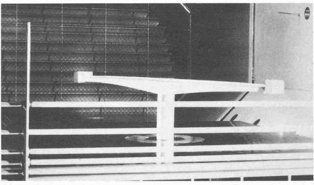
Windkanalversuch. Brücke im Bauzustand bei max. Austragung des Überbaues mit zwei Freivorbauwagen
