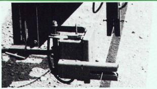
drahtgesteuerter Einbau von Betonbelägen für hohe Qualitätsansprüche WALO
