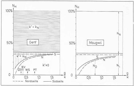
Bild 2. Statistik der Deckungs- und Lichtstunden
