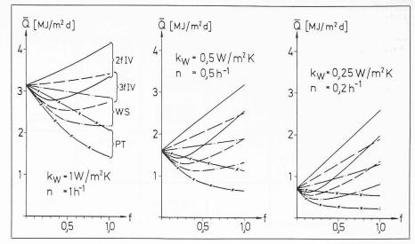
$Bild \ 5. \quad Mittlerer \ Heizbedarf \ Q \ pro \ m^2 \ Fassade \ und \ mittleren \ Heiztag \ in \ Funktion \ des \ Fensterante ils \ funktion \ des \ funktion \ f$
