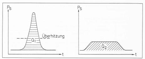
Bild 3. Unterschiedlicher Einstrahlungsverlauf, qualitativ
