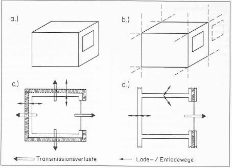
Bild 8. Vergleich Messbox mit Raum im Gebäudeverband
