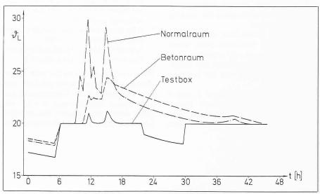
Bild 9. Verlauf der Lufttemperatur für 2 Januartage
