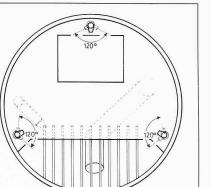
Bild 8. Aufbau des in Hamburg verwendeten Hydrojetschildes
