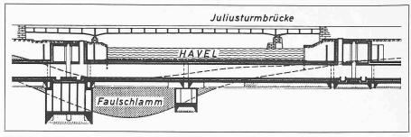
Bild 14. Senkkastenbauweise bei der Havelunterfahrung
