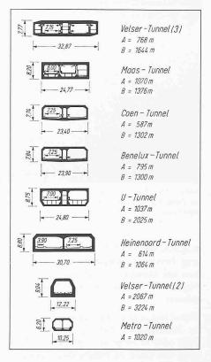
Tabelle 1. Einige Unterwassertunnel in den Niederlanden mit technischen Einzelheiten über die Bauausführung (vgl. Bild 4)
