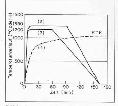
Temperaturverläufe bei verschiedenen Brandbelastungen im Strassentunnel. (1) Einheitstemperaturkurve (ETK) nach DIN 4102, Teil 2, (2) angenommene Brandbelastung in Strassentunneln bei Bränden von Gütern mit hohem Heizwert und (3) Brandbelastung, der ein Wärmedämm-Spritzputz (Pyrok) standhielt
