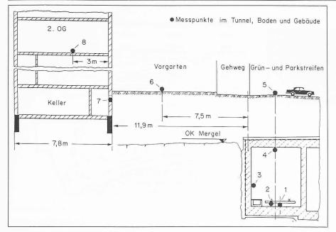
Bild 12. Anordnung der Messpunkte für Körperschall- und Erschütterungsmessungen
