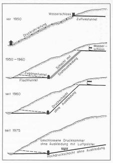
Bild 1. Entwicklung der Gestaltung von Wasserkraftanlagen in Norwegen
