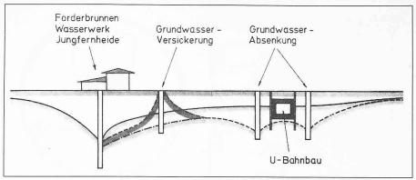
Anordnung der Versicherungsbrunnen im Absinktrichter der Wasserwerke
