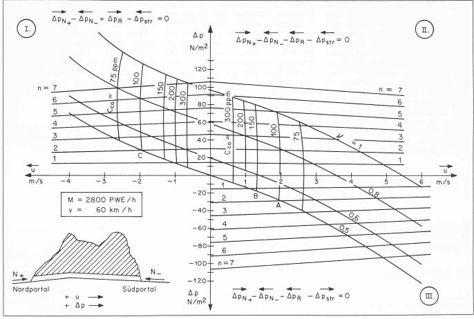
Bild 1. Kennlinienfeld eines längsbelüfteten Strassentunnels. Verkehrsart: Gegenverkehr
