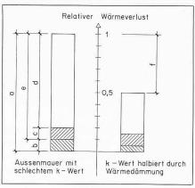
Bild 2. Relativer Wärmeverlust eines Bauteils bei k-Wertverminderung
