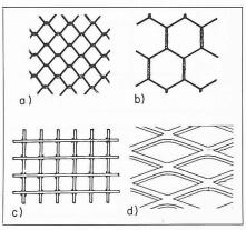
Bild 4. Bewehrung für Ferrozement a) gewobenes Gitter b) Hühnergeflecht c) geschweisstes rechteckiges Gitter d) Streckmetall
