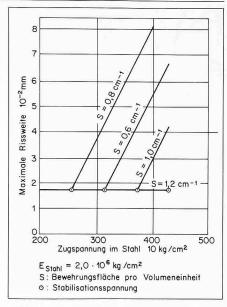
Bild 7. Maximale Rissweite (A. Naaman)
