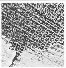
Bild 3. Prinzip des Ferrozements (Photo: Noel D. Vietmeyer)
