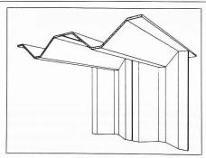
Bild 14. Faltwerk aus Ferrozement (Piet Stroeven, Delft University)
