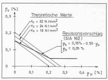
Bild 2. Bewehrungsgehalte, um eine Risseverteilung zu gewährleisten
