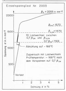
Bild 1. Spannungs-Dehnungsdiagramm eines Einzeldrahtes Ø 7 mm. Versuchsdurchführung gemäss Vorschlag IfBt
