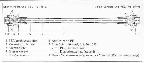
Bild 3. Einzelspannglied ohne Verbund des Spannverfahrens VSL
