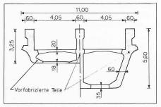
Bild 4. Teilweise vorfabrizierter Querschnitt der Brücke von Clichy
