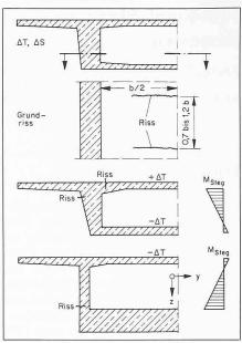
Bild 13. Risse in Kastenquerschnitten
