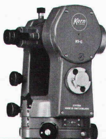
Kern K 1-S. Ingenieurtheodolit mit Skalenablesung
