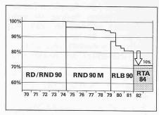
Bild 2. Sulzer-Dieselmotorenentwicklung 1973: Verringerung des Brennstoffverbrauchs um 28 Prozent, bezogen auf das gleiche Schiff bei Normal-
