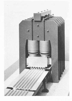
die Oberflächenqualität des Produktes, was vor allem bei gefärbten Platten sehr wichtig ist. Ein am oberen Presstisch montiertes Auf- bzw. Abrollsystem ermöglicht das Wechseln der Membrane während der Produktion. Der Aufbau
