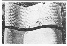
Zwei verschieden behandelte Wellplattenmuster, die über 20 Zyklen dem Einfriertest im Block unterworfen wurden. Die Proben wurden vollständig in Wasser getaucht, eingefroren. Die gepressten Proben (untere Bildhälfte) blieben - mit Ausnahme von Anzeichen von Lagentrennung und kleinen Absplitterungen - unverändert. Bei den ungepressten Proben (obere Bildhälfte) begannen die Frostschäden rasch und progressiv voranzuschreiten
