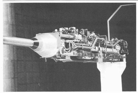
Bild 5. Torpedo mit den hydraulischen Steuerungs- und Verstelleinrichtungen
