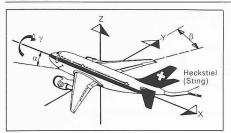
Bild 2. Bewegungen am Flugzeugmodell. X: Widerstand Y: Seitenkraft Z: Auftrieb α: Anstellwinkel β: Schiebewinkel γ: Rollwinkel
