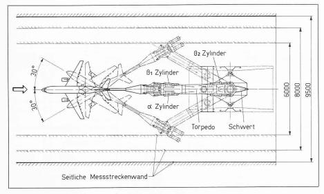
Bild 6. Torpedo. Schiebewinkelmechanismus
