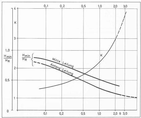
Approximation für Luftkessel, Minimaldruck in Leitung und Expansionskoeffizient
