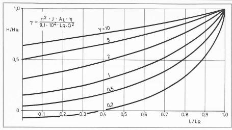
Bild 2. Approximation für Schwungrad, Druckverlauf entlang der Leitung
