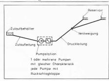
Bild 10. Schema einer Anlage
