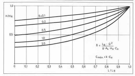
Bild 5. Approximation für Luftkessel, Druckverlauf entlang der Leitung
