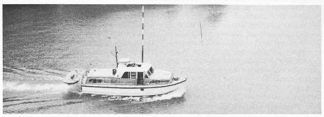
Das Vermessungsschiff «Explorer» des Vermessungsbüros Dr. Schlund auf dem Walensee. Die Wassertiefe wird mit einem Ultraschall-Echolot kontinuierlich gemessen und aufgezeichnet. Die Positionsbestimmung des Schiffes erfolgt mit Hilfe von Laserstrahlen ebenfalls kontinuierlich von einer Landstation aus; alle Messwerte werden im Bordcomputer verarbeitet
