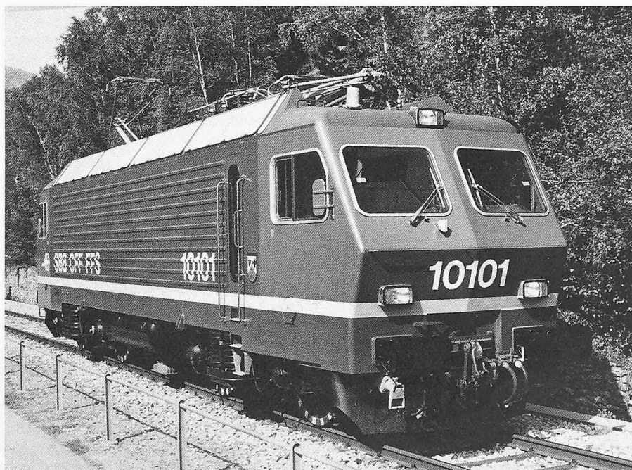
Bild 1. Lok 10101 bei der Inbetriebsetzung. Die weissen Marken an den Radbandagen dienen zur Sichtbarmachung des Radschlupfes bei schweren Anfahrten
